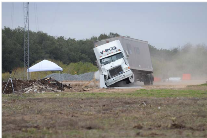
Nárazová zkouška při 80 km/h tahače o hmotnosti 36 000 kg
