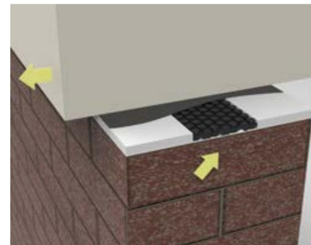
Aufnahme von Unebenheiten in der Oberfläche werden über die Lagerhöhe ausgeglichen und schränken die Verformungsmöglichkeiten nicht ein.
