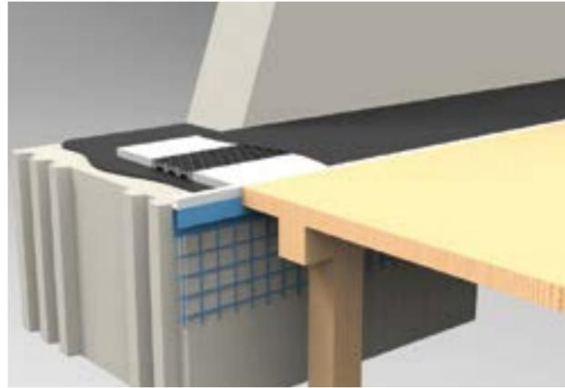
Cigular®-Deckenlager werden mit nach oben weisender Kunststoffabdeckung, stumpf gestoßen, auf die Auflagerflächen der Tragkonstruktion gelegt. Die Stoßfuge wird von den einseitig überstehenden Abdeckstreifen überdeckt. Dieser selbstklebende Abdeckstreifen muss auf das zuvor verlegte Lager vollflächig aufgedrückt werden, so dass später beim Betonieren der Decke die Stoßfuge geschlossen und damit funktionsfähig bleibt.
