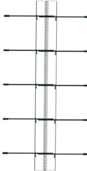
Bild 14: Regelfall Schlaufenüberlappung
