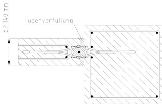
Bild 6: Stützen - Wandverbindung
