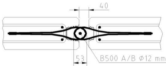
Bild 14: Maximale Fugenbreite
