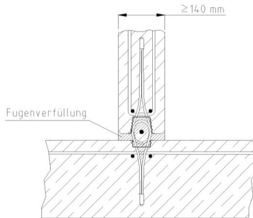
Bild 9: Wand - Wand – T-Verbindung - Regeldetail
