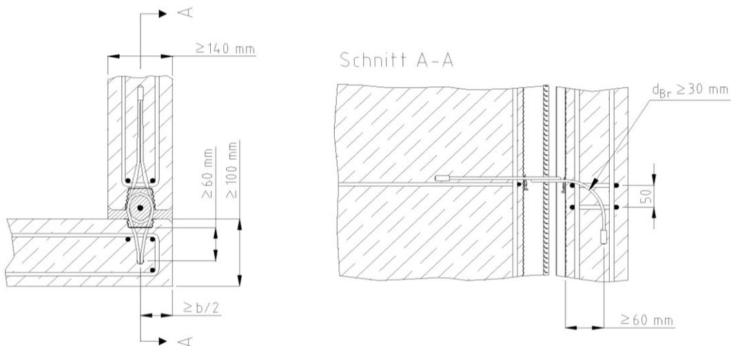
Bild 8: Wand - Wand – Eckverbindung - Detail bei abgewinkelter Seilschlaufe
