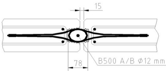
Bild 13: Minimale Fugenbreite
