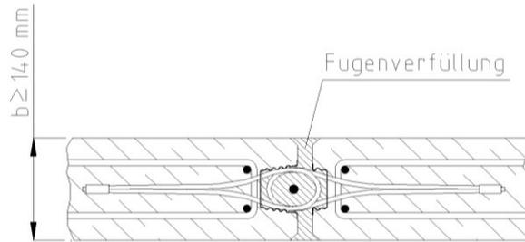
Bild 5: Wand - Wandverbindung
