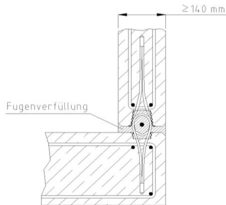
Bild 7: Wand - Wand – Eckverbindung - Regeldetail
