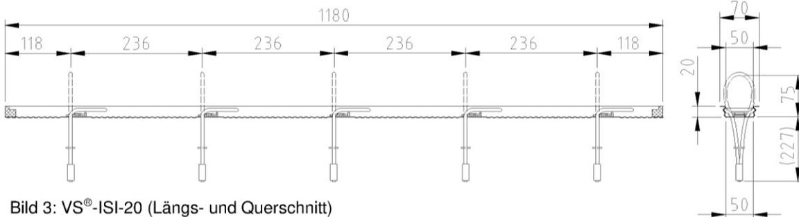
Bild 3: VS®-ISI-20 (Längs- und Querschnitt)
