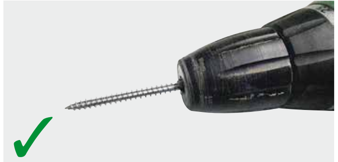
Bild 9: Detail – Bohraufsatz (Spanplattenschraube Ø 6 mm ohne Kopf)
