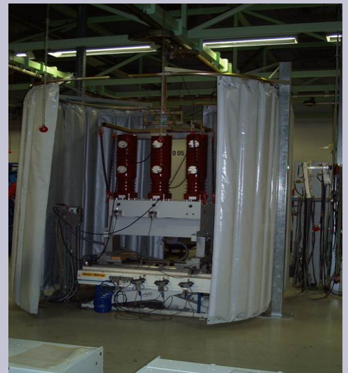
mobiles Vorhangsystem (an Rollschienen befestigt)
