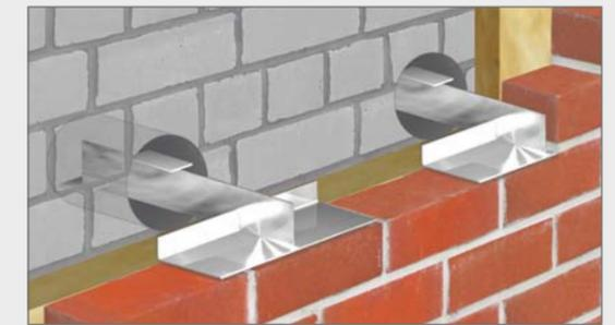
In bestehendes Tragwerk eingesetzte Einmörtelkonsolen mit Wärmedämmung und Verblendfassade
