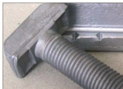
Kerbzähne der Schraube drücken sich in die Schienenlippe ein.
