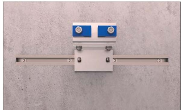
Nach dem Einbau richtigen Sitz der Schraube in der Ankerschiene kontrollieren – der Markierungsschlitz muss quer zur Schienenlängsrichtung stehen
