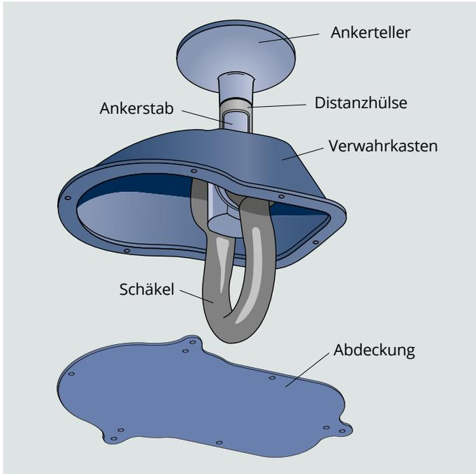
Die Lastöse ist vorgesehen für den Einbau in flache Decken aus Stahlbeton in einer Mindestgüte von C25/30. Hierbei stehen folgende Optionen zur Verfügung:
