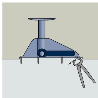
3. Gegebenenfalls Deckel durch Loch mit ziehen entfernen
