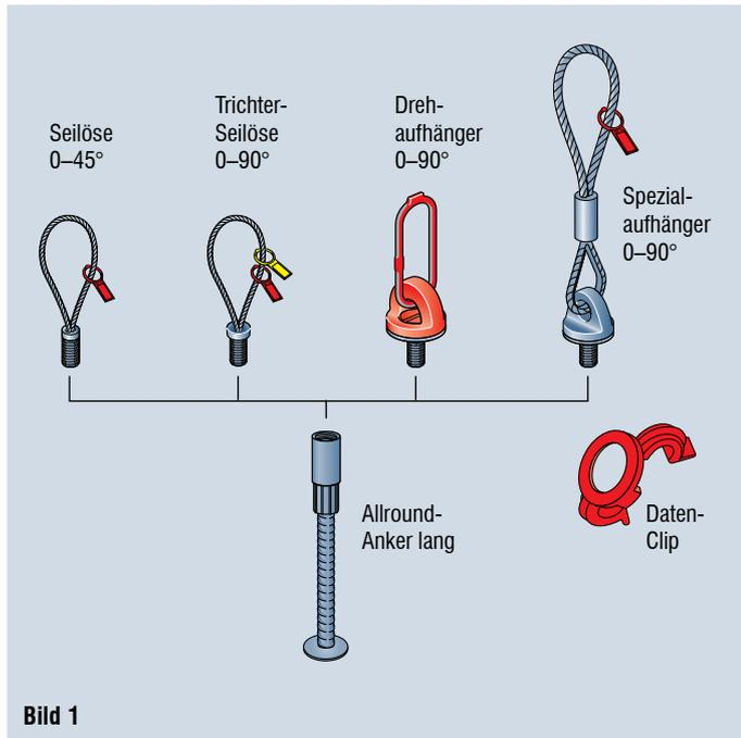
Das Lastaufnahmemittel PFEIFER-Gewindesystem besteht aus Transportankern, Abhebern, farbcodierten Datenclips und einem umfangreichen Sortiment an Zubehörteilen.
