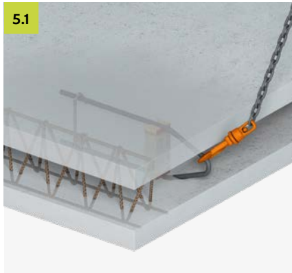
5.1 Randferner Einbau: Bei Querzug Gitterträger als Randeinfassung
