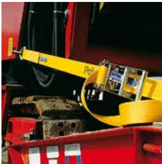
Diagonalverzurrung bei schweren Lasten
