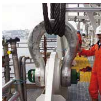
Breitkörperschäkel mit vergrößerter Auflagefläche
